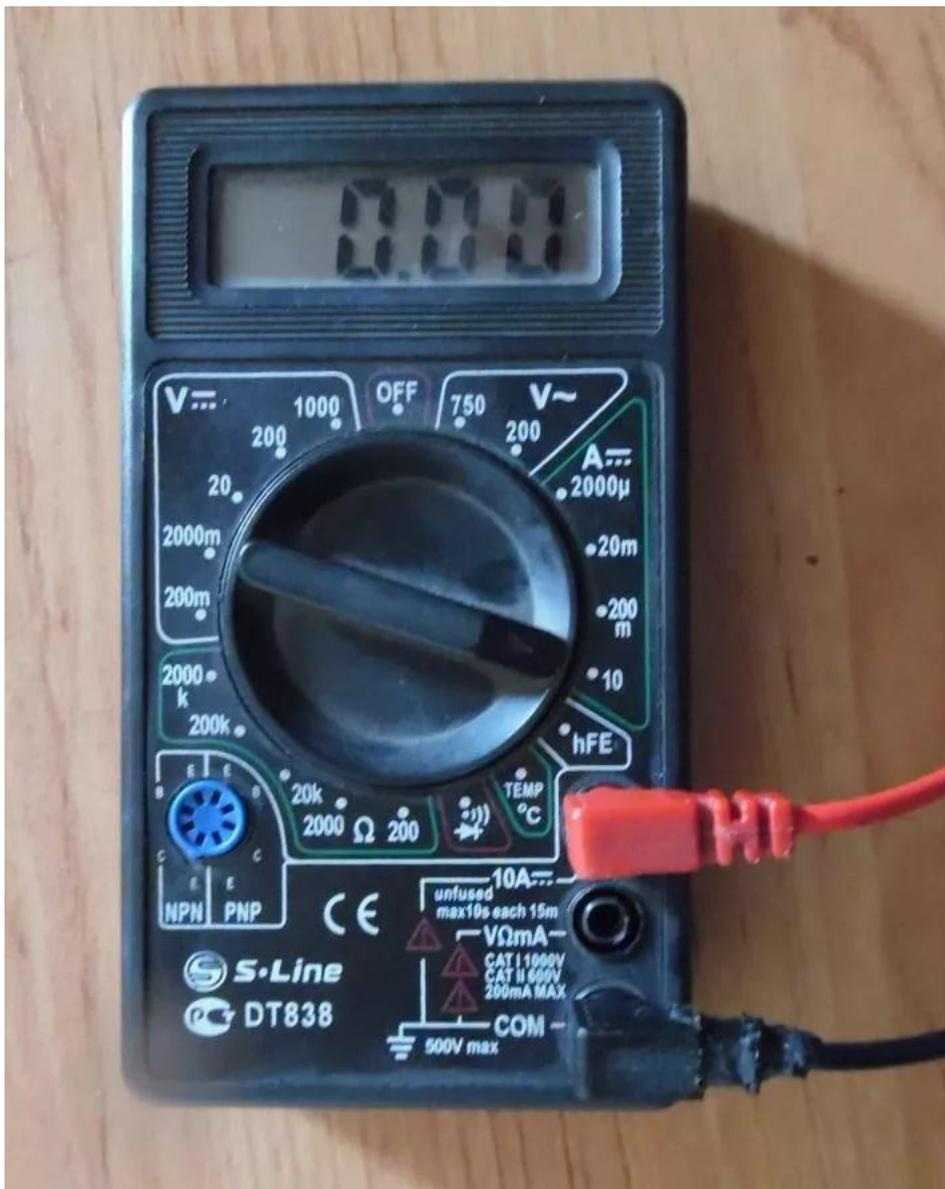
Цифровой мультиметр предназначен для измерения силы тока, постоянного, переменного напряжения, сопротивления, емкости конденсаторов, определения целостности цепи и проверка наличия или отсутствия контакта (прозвонка цепи)
